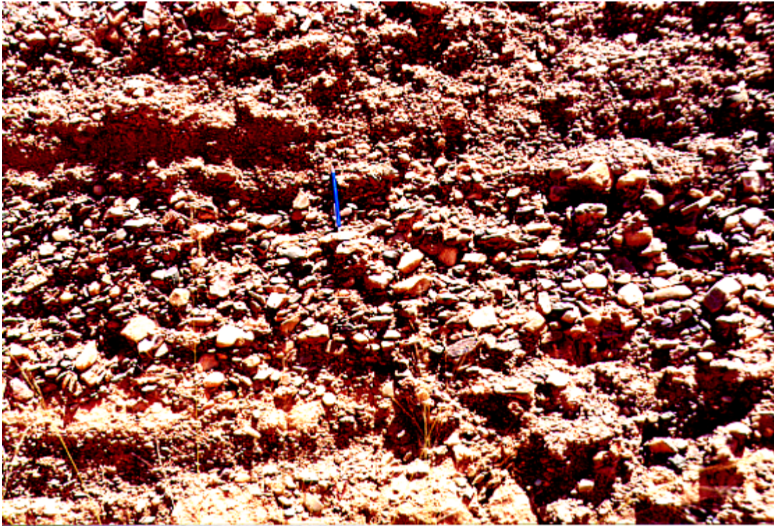
Fotografía 94.- Columna estratigráfica de Moral de Calatrava I. Detalle de las facies de conglomerados con los clastos imbricados.
