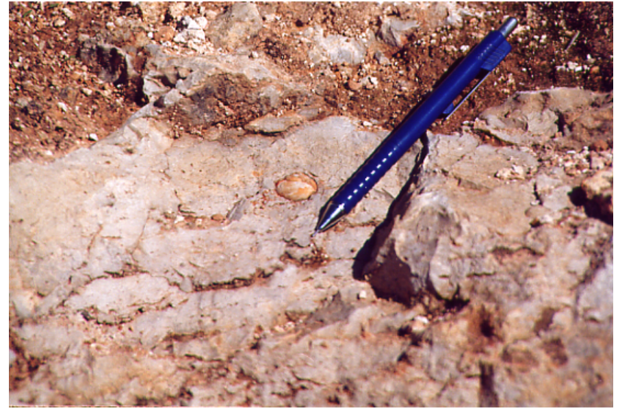
Fotografía 140.- Columna estratigráfica de la Cantera de Santa Cruz de Mudela. Detalle de la capa de caliza donde aparecen fósiles de gasterópodos dispersos.
