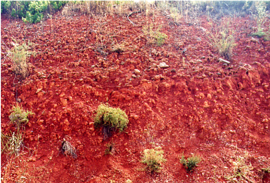
Fotografía 97.- Columna estratigráfica de Valdepeñas I. Tránsito entre los limos del tramo 4 y los paraconglomerados del tramo 5.
